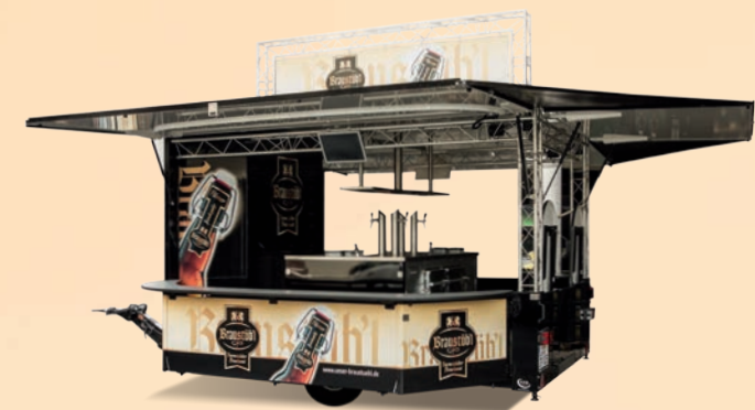
Ausschankwagen „Traverse“ Maße: Geschlossen mit Deichsel L = 6,10 m, B = 2,33 m, H = 3,82 m Offen ohne Deichsel L = 6,60 m, B = 5,85 m, H = 3,82 m
