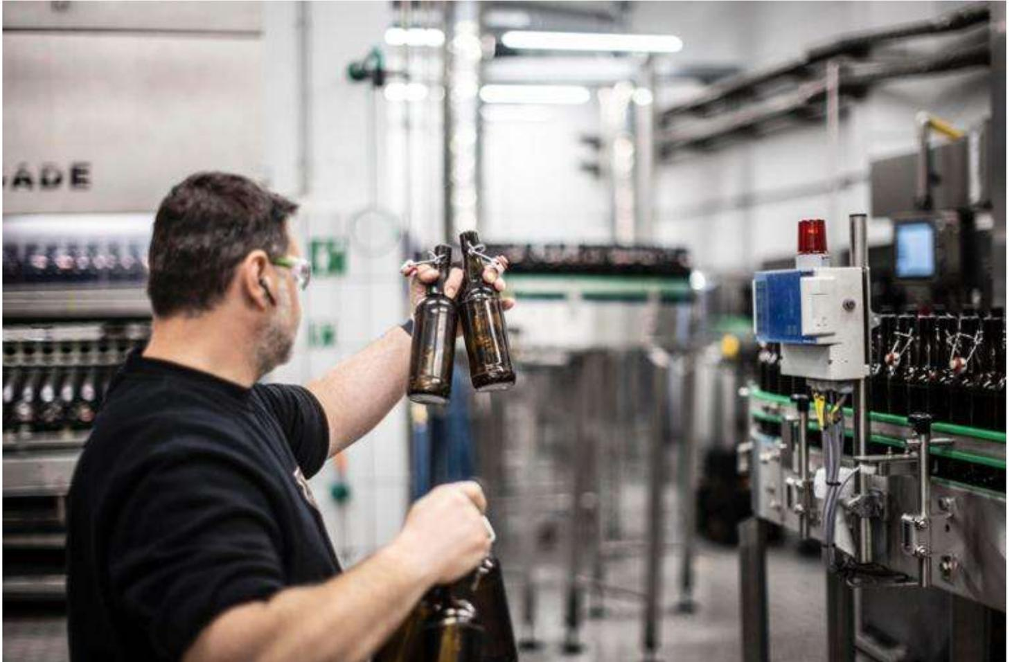
Prüfender Blick: Defekte Flaschen werden in der Abfüllanlage in einem automatisierten verfahren aussortiert. © Michael Schick
